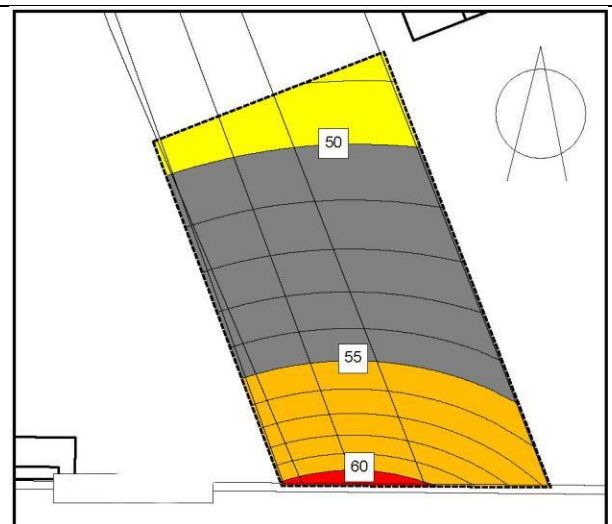
Abbildung 6: Sportanlagenlärm ISO dB-Flächen ohne Bebauung, H = 5m (ohne Maßstab); Quelle: schalltechnische Untersuchung, Draeger Akustik
