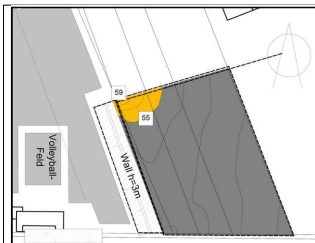
Abbildung 9: Sportanlagenlärm ISO dB-Flächen ohne Bebauung, H = 2m (ohne Maßstab); Quelle: schalltechnische Untersuchung -Ergänzung-, Draeger Akustik
