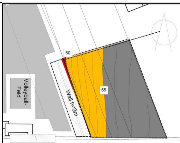
Abbildung 10: Sportanlagenlärm ISO dB-Flächen ohne Bebauung, H = 5m (ohne Maßstab); Quelle: schalltechnische Untersuchung -Ergänzung-, Draeger Akustik
