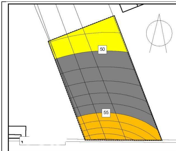
Abbildung 5: Sportanlagenlärm ISO dB-Flächen ohne Bebauung, H = 2m (ohne Maßstab); Quelle: schalltechnische Untersuchung, Draeger Akustik
