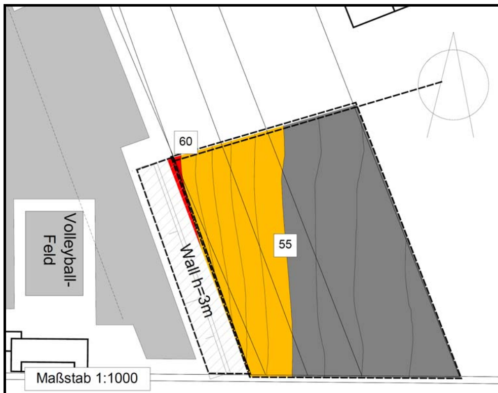
Abbildung 2: Variante 1 mit 3 m hohem Wall, Kronenbreite 1 m, Fußbreite 10 m, Immissionsorthöhe h = 5 m
