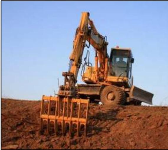
Einsatz eines Mobilbaggers mit Wurzelrechen zum Ausgraben der größeren Wurzelstöcke. 01.02.2012
